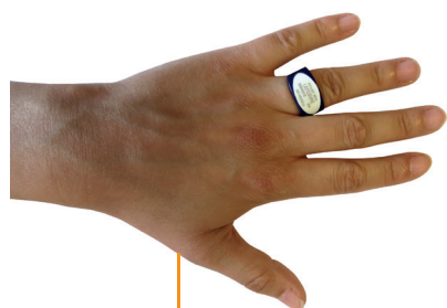
Plasser ringen på passende finger med etiketten mot strålekilden
